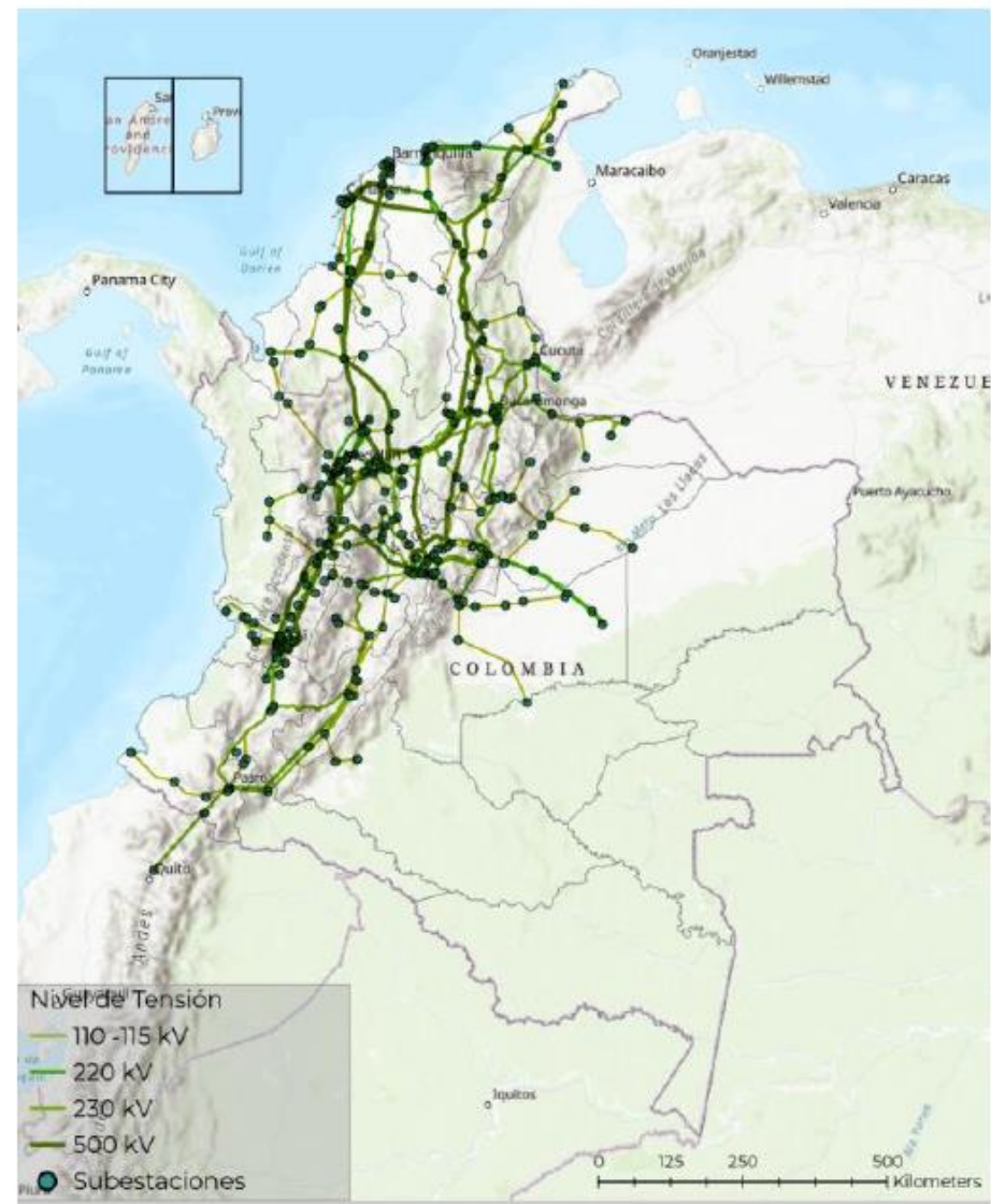
Líneas de transmisión y subestaciones
