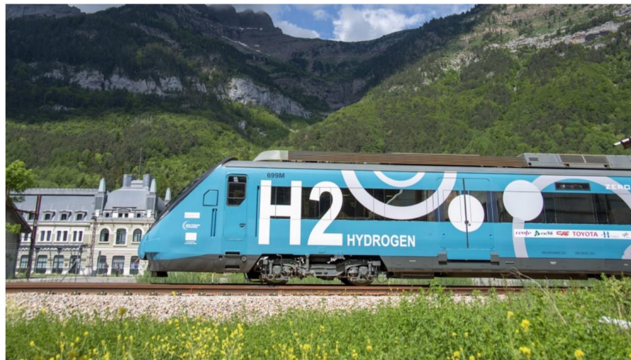
Podrá funcionar mediante la catenaria o gracias a la pila de combustible de hidrógeno.
