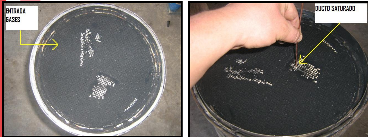
Filtro DPF saturado por rotura turbocompresor
