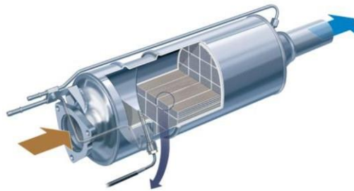
Figura 10. Filtro de partículas diesel (DPF) Fuente. Autofácil, 2018
