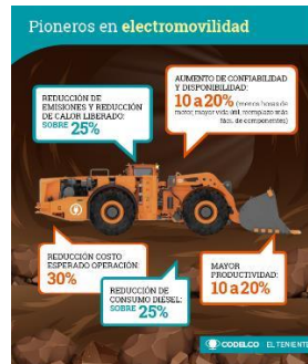
Figura 11. Cargador eléctrico en una demostración de operación
