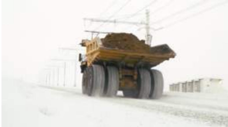
Figura 6. Sistema de asistencia de trole Cat para camiones mineros de accionamiento eléctrico.
