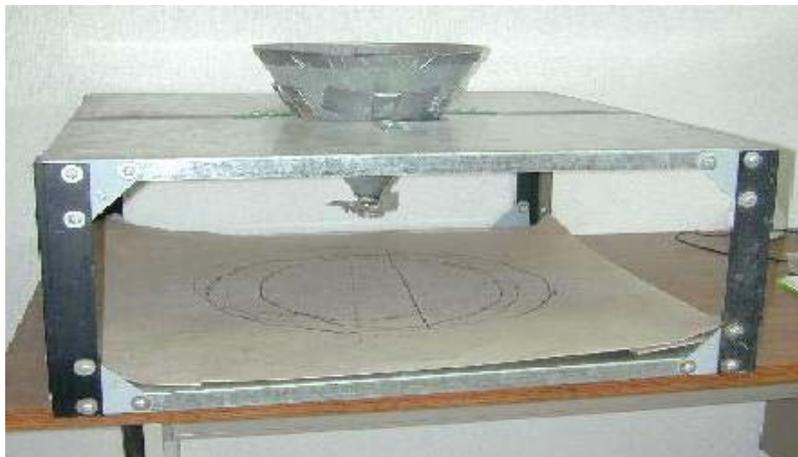
**FIGURA 2.- Medidor de ángulo de reposo (MAR)**
