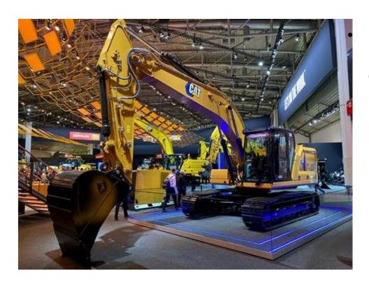
La excavadora Cat 320 viene con un cargador integrado de 22kW, que cargará la batería entre 10 y 15 horas
