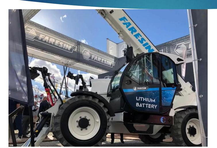
El paquete de baterías de la gama Big Range Full Electric alimenta dos motores eléctricos, un motor de 51kW para la transmisión y un motor de 23kW dedicado a los servicios de la máquina
