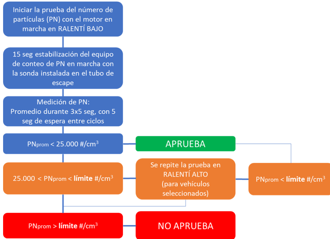
Figura 24. Procedimiento de medición de PN en buses de Transmilenio en Bogotá.
