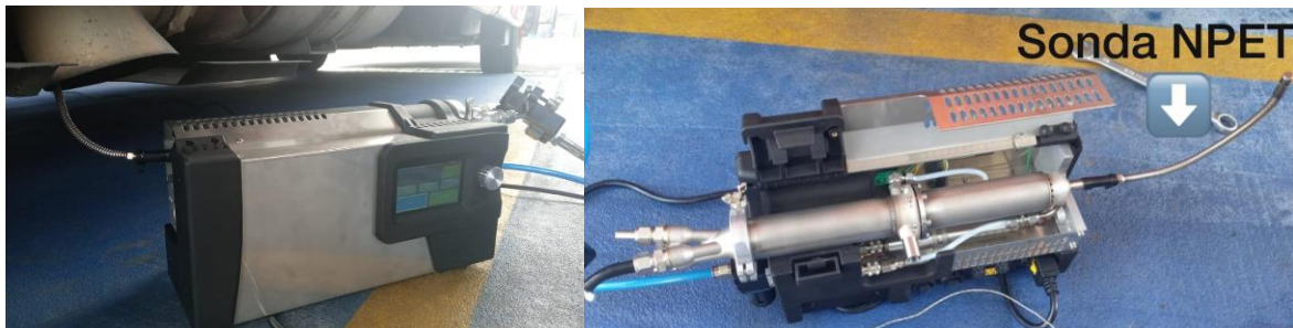
Figura 21. Dilutor eDiluter marca Dekati (izquierda), adaptación sonda del NPET (derecha).
