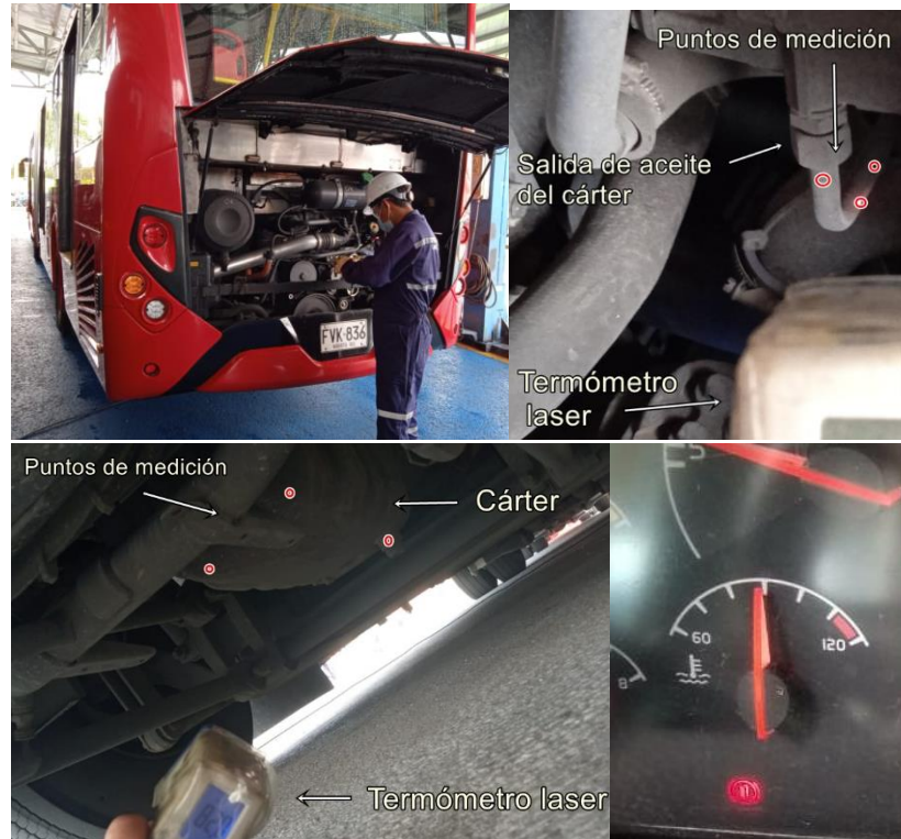
Figura 23. Medición de la temperatura del cárter en la parte trasera del bus (izquierda), debajo del bus (centro), en el tablero del bus (derecha).
