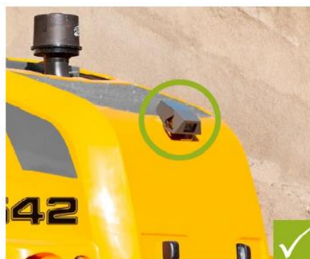
Figura 16: Ejemplos de montaje de espejos y cámaras adicionales.
