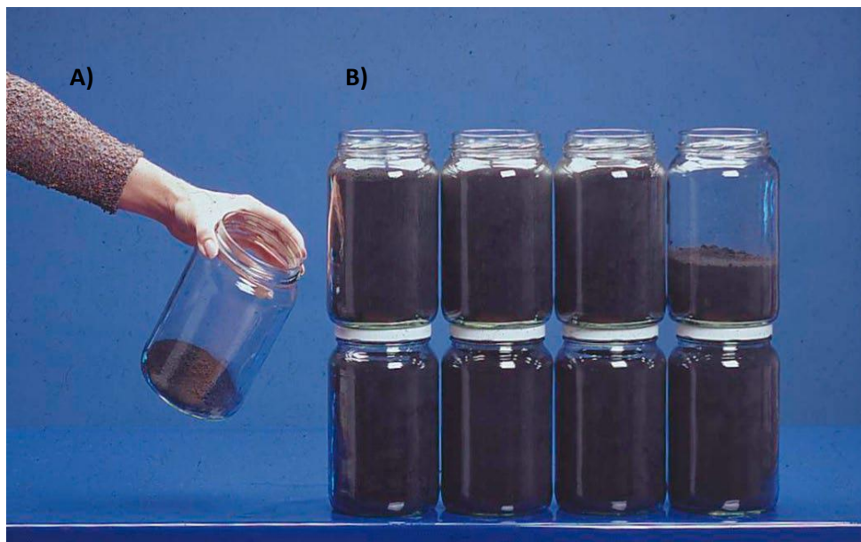
Figura 4: Comparación de las emisiones de hollín de un vehículo Euro III: A) con filtro de partículas 100 g y B) sin filtro de partículas 3 kg (3.000 g) de hollín.
