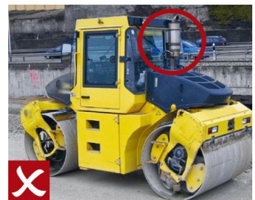
Figura 15: Comparación de la instalación incorrecta y correcta de un filtro de partículas
