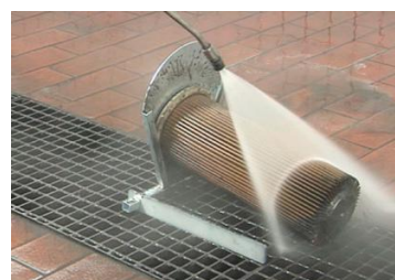
Figura 24: Limpieza del filtro por medio de agua a alta presión
