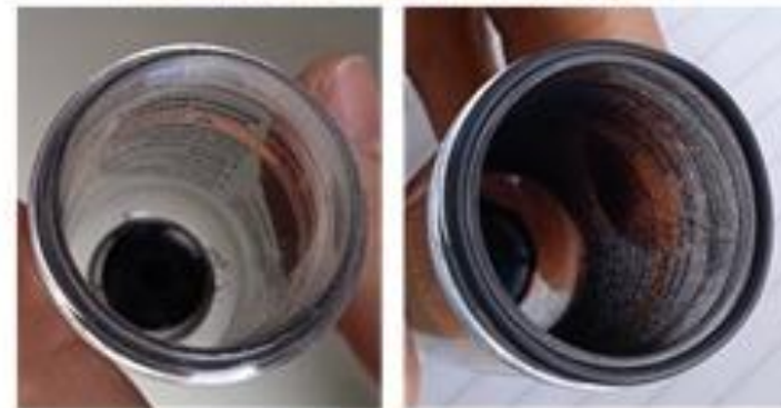
Presencia de hollín en trampa
