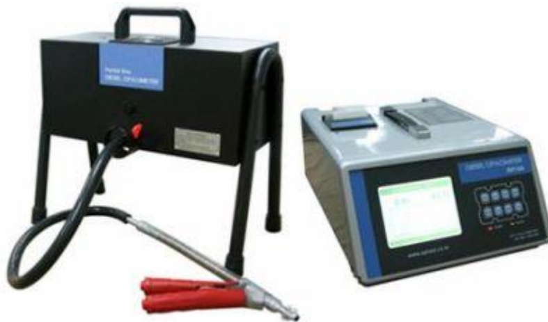
Ilustración 8: Opacímetro certificado bajo ISO 11614 de flujo parcial (cámara cerrada).
