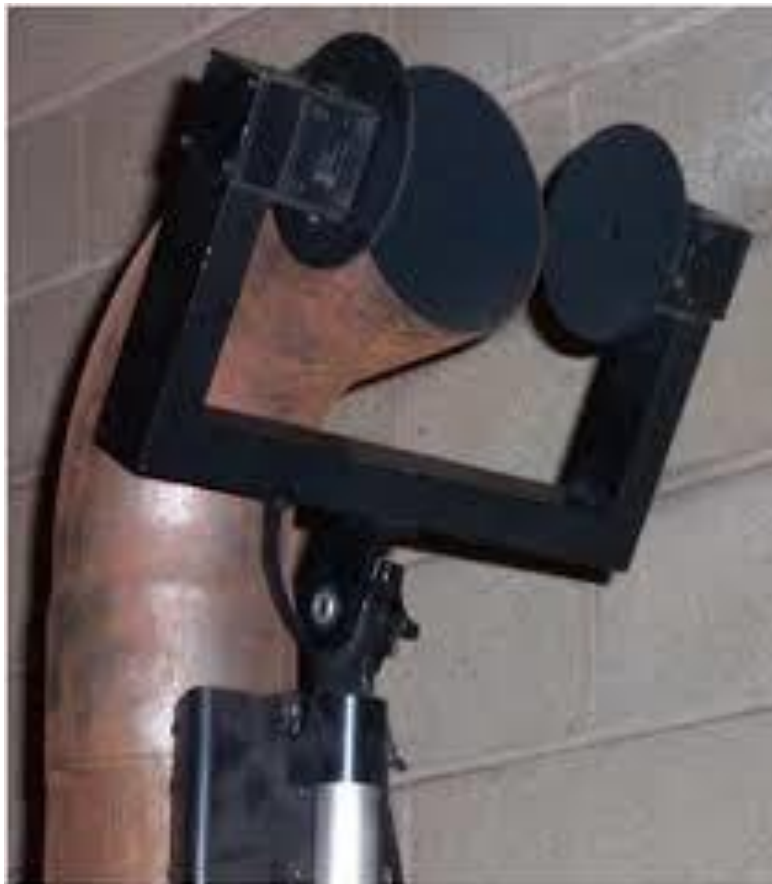
Ilustración 7: Opacímetro SAE J 1667 (flujo total a cámara abierta).
