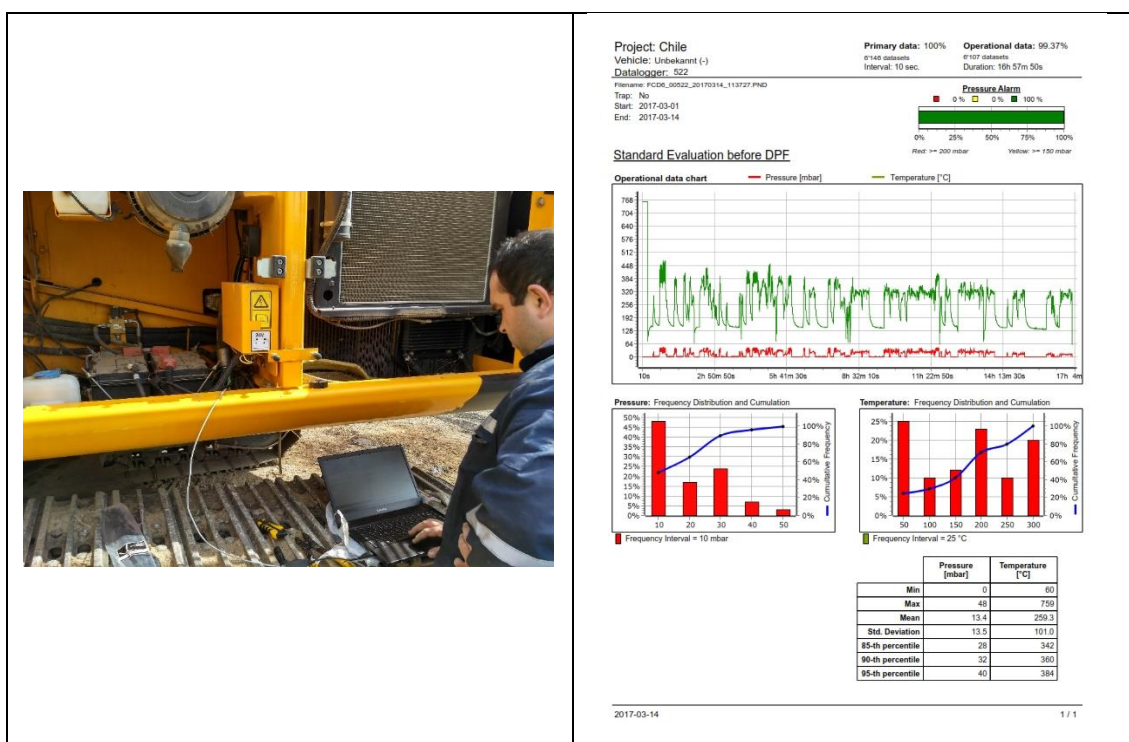
Figura 21: Descarga de datos de máquina excavadora JCB en proceso de pre datalogging.
