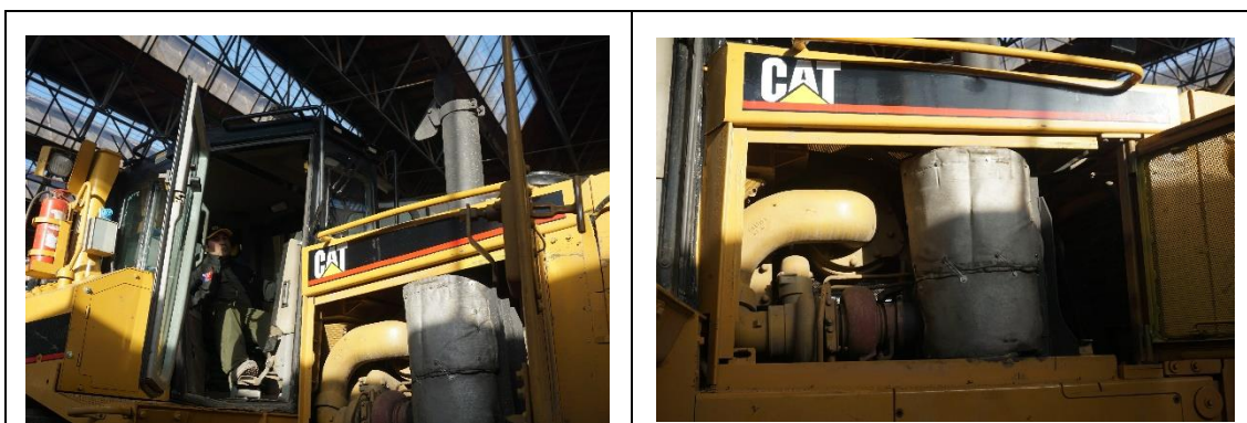
Figura 18: Bulldozer oruga Caterpillar D8R parte de la flota del Ministerio de Obras Públicas de Chile, reacondicionada con DPF.
