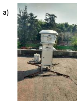
a) Muestreador de altos volúmenes b) Tren de muestreo con dos EPU
